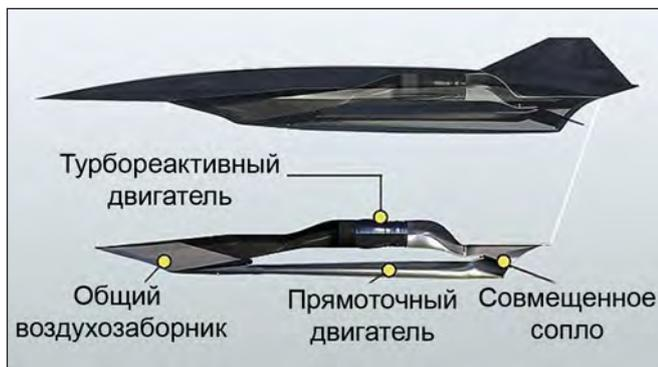
Рис. 2. Принципиальная схема силовой установки ГЛА «Валькирия II»
