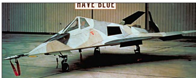
Рис. 4. Демонстратор технологий снижения радиолокационной заметности самолет Локхид F-19 «Хэв Блю»
